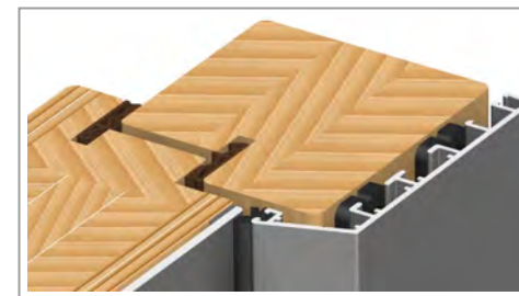
Detail - Alu-Schale Außen & drei Dichtungsebenen
